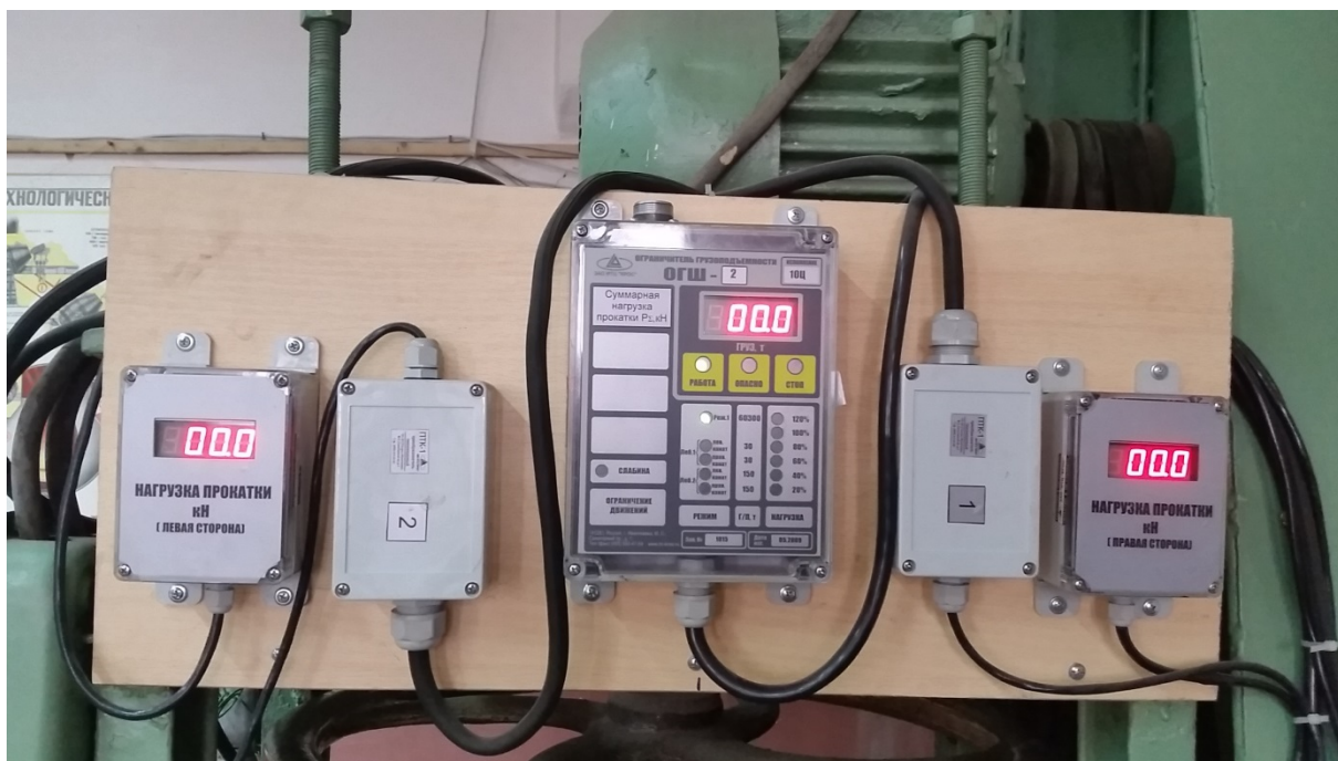
Рис. 2.5. Измерительная аппаратура, установленная на стан 150x235.
