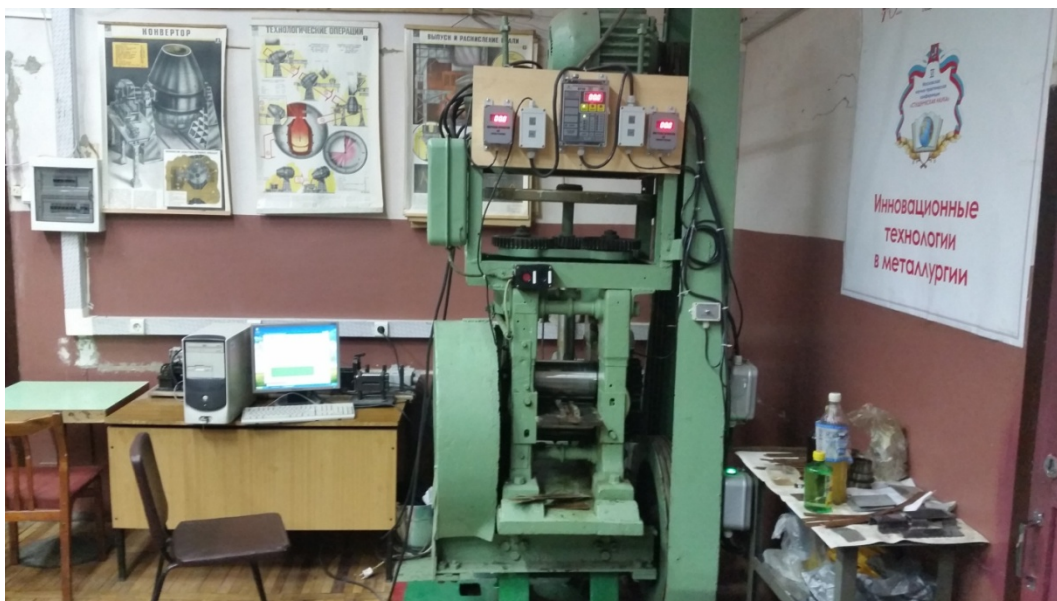
Рис. 2.1. Фрагмент лаборатории и прокатный стан 150x235 с установленной системой контроля усилий прокатки.
