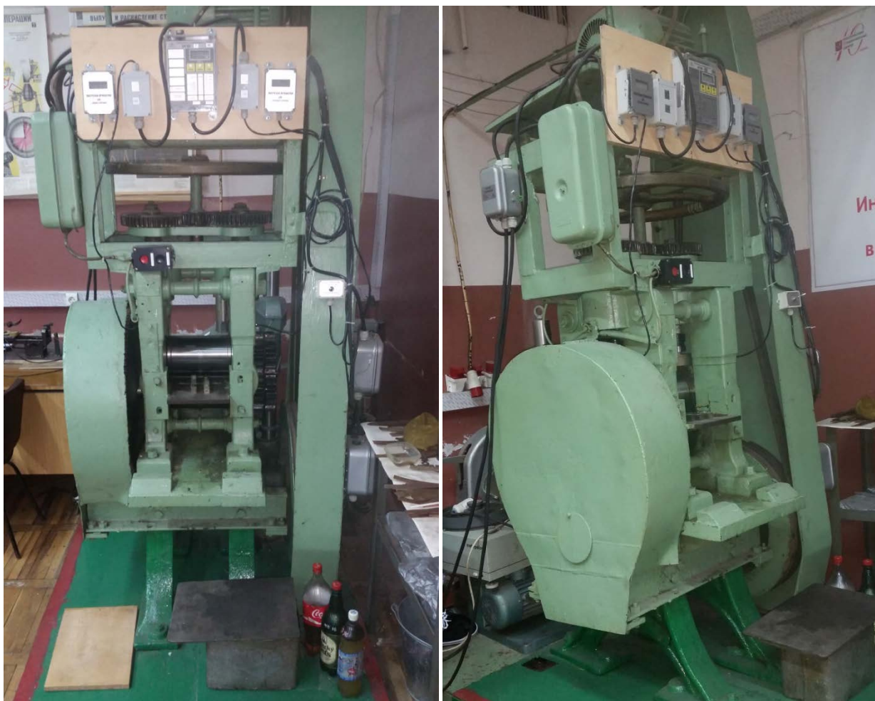
Рис. 2.6. Общий вид лабораторного двухвалкового стана 150x235.
